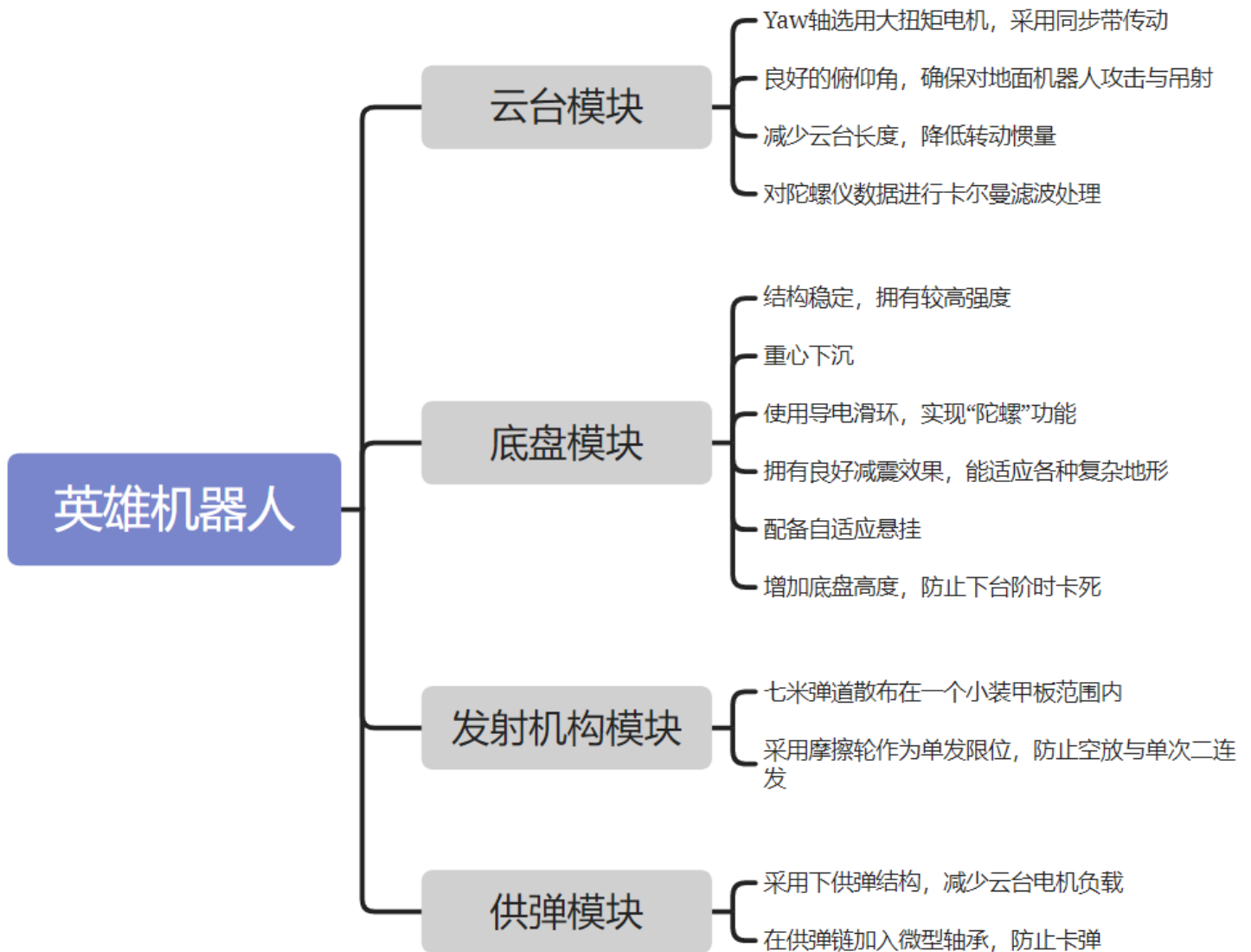
图 2-2 英雄机器人设计思路
